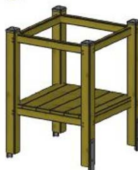
Viereckturm, Best. Nr. 52j-110-x in den Podesthöhen 0,25 / 0,50 / 0,75 / 1,00 m
